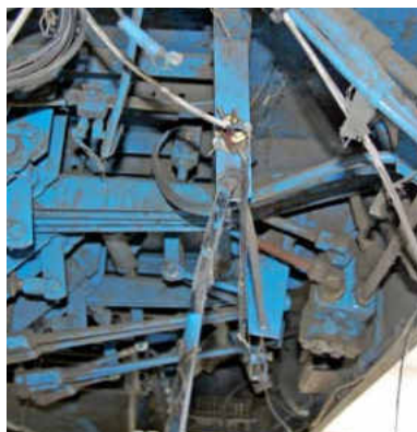
W instalacji pomiarowej Pawła Tomczaka zerwała się sprężyna odpowiadająca za przerywanie pracy hektaromierza. Stycznik powinien reagować na wyraźne podniesienie hedera.
