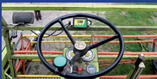
Informator pokładowy rolnik umieścił na wprost oczu, za kierownicą. Został on przykręcony do barierek pomostu operatora.
