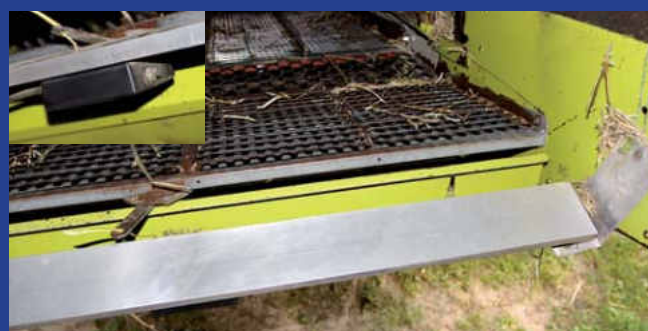
W starszym rozwiązaniu pod belką wykonaną z aluminium znajduje się układ elektroniczny z jednym przełącznikiem o trzech położeniach.
