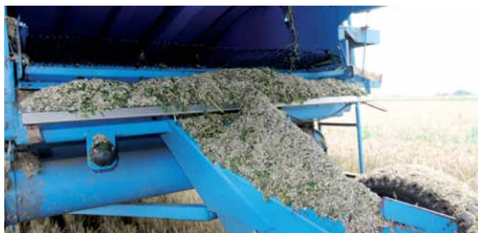
Podczas naszej wizyty u rolnika z Krerowa okazało się, że belka pomiarowa była ustawiona zbyt płasko i dość wilgotny materiał z sit gromadził się na niej, zamiast zsuwać się na pole. Po skorygowaniu położenia czujnika problem został rozwiązany.
